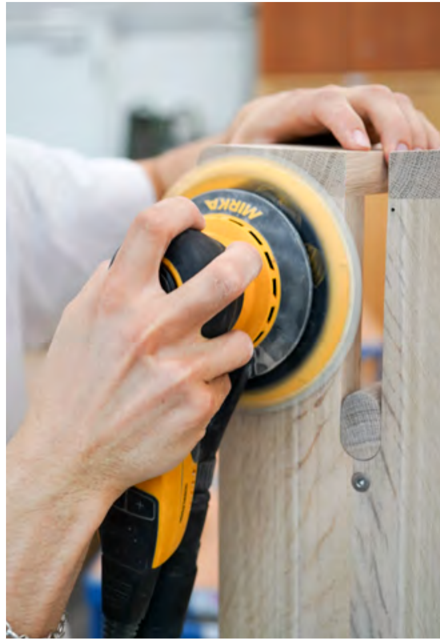
最終研磨 研磨加工された後のオーク材はそのままの自然な状態か、用途によっては環境に配慮されたオイルもしくはニスで仕上げられる。
